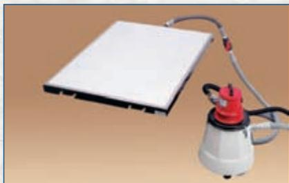
Стационарный стол предназначен для удаления избытков влаги и клеевой обработки документов после процесса доливки.
