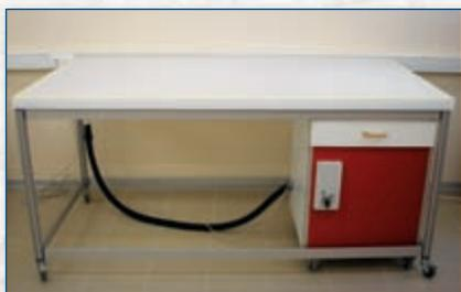
Предназначен для удаления избытков влаги и клеевой обработки документов после процесса доливки.
