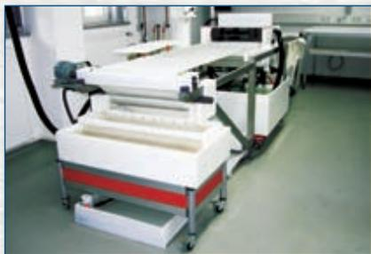
Автоматический листодоливочный комплекс с конвейерной подачей листов, применяется при больших объемах реставрации, позволяет проводить полный цикл листодоливочного процесса.
